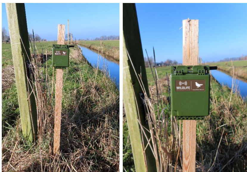
Figuur 8.2. Geluidsrecorders onder de hoogspanningsverbinding namen 24 uur per dag de geluiden van overvliegende vogels op.
